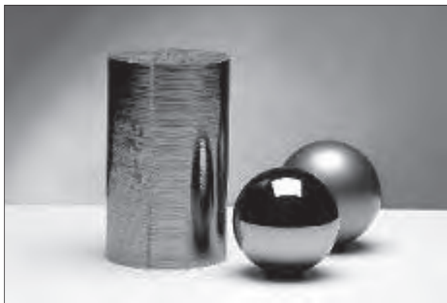
Obr. 1: Křemíkové koule používané v projektu Avogadro
